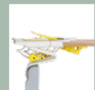
Suspension: L'élément clé de bico-flex® est le système de suspension dit «en C», qui permet un positionnement souple du corps dans toutes les positions de sommeil. Les suspensions avec une course de 3cm se composent de plastique Hytrel® résistant à la fatigue et garantissent une robustesse optimale durant de nombreuses années.
